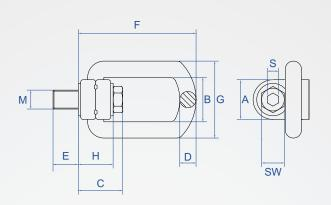
材質 吊環 鍛造合金鋼 螺栓 合金鋼
